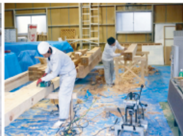
↑ 大工さんによる柱・梁の加工
