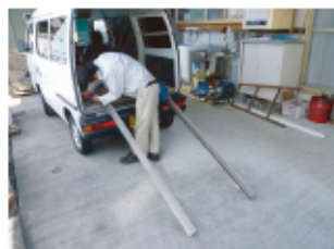
↑交換用のドア枠の組み立て中の様子です。
